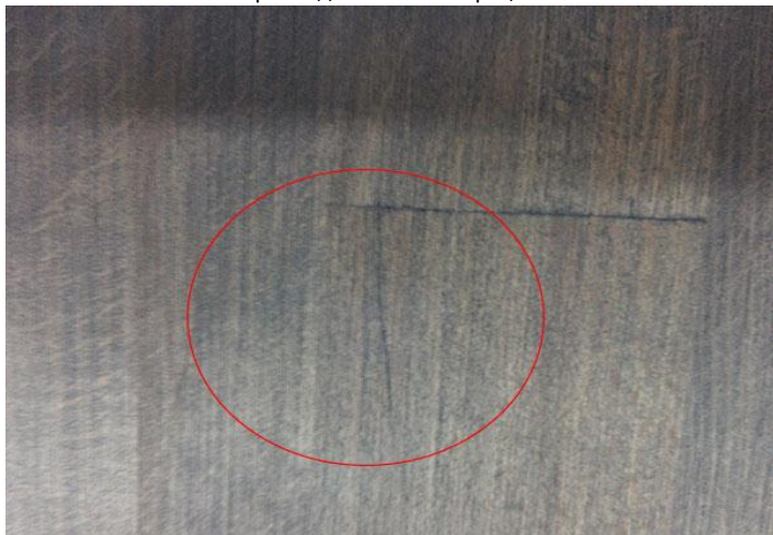
Приклад пластівцевої тріщини
