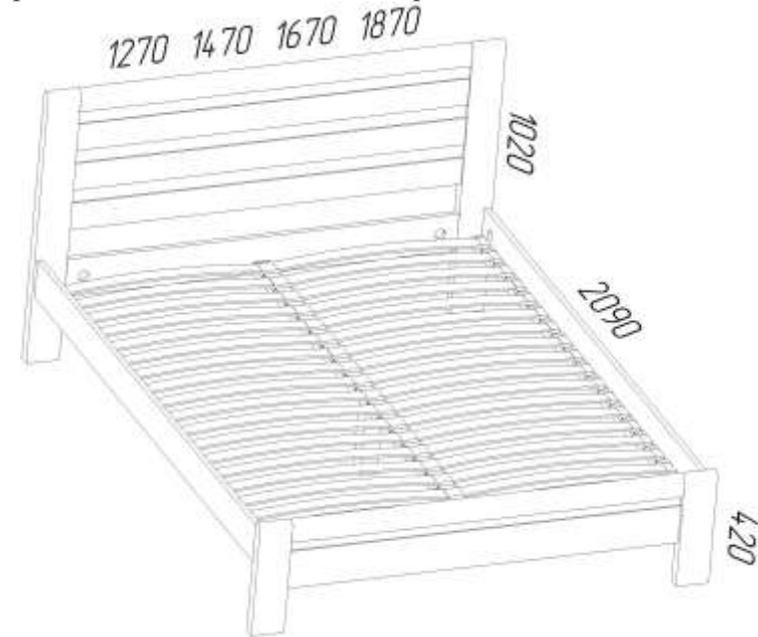
**Технические характеристики:** конструкция кровати «Люкс» из массива, состоит из двух спинок (задняя, передняя), а также двух боковых царг и продольной царги, соединенных между собой поперечной планкой. Мебельные детали изделия тонированы красителем и покрыты бесцветным лаком со всех сторон. В состав изделия входят ламели.
